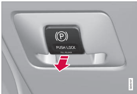
Ручка стояночного тормоза – тормоз отпущен.
