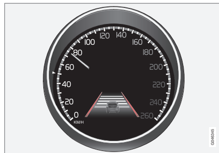
Боковые линии, обозначаемые функцией LDW (на рис. красного цвета).
