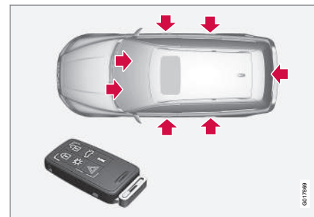
Точки запираения дистанционным ключом с плоским ключом.
