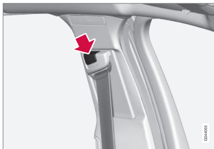
Регулировка ремня безопасности по высоте. Нажмите кнопку и переместите ремень безопасности по высоте. Установите ремень как можно выше, но так, чтобы он не касался шеи.
