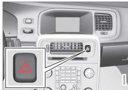
Кнопка аварийных мигающих сигналов.
