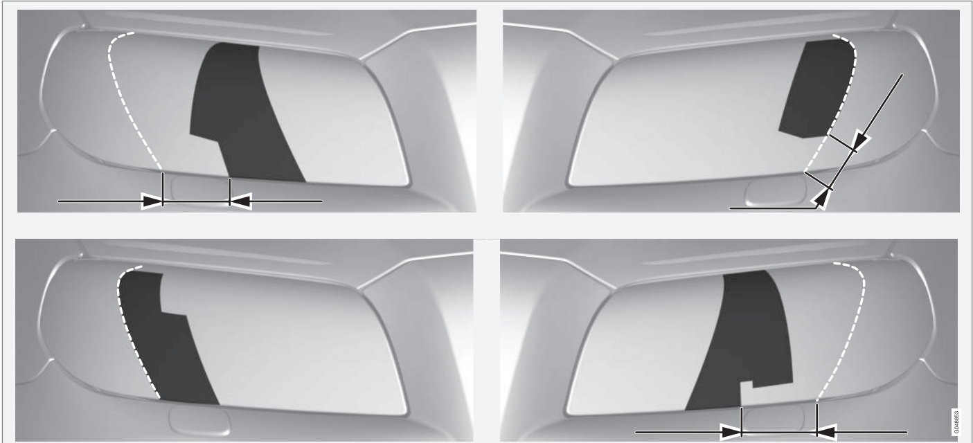
Верхний ряд: автомобиль с левосторонним управлением, шаблоны А и В. Нижний ряд: автомобиль с правосторонним управлением, шаблоны С и D.
