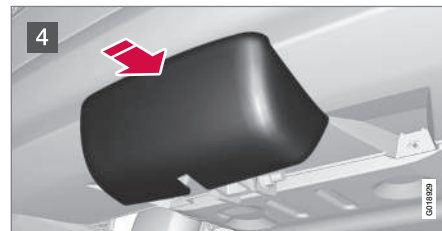
4 Задвинув, зафиксируйте защитную крышку.
