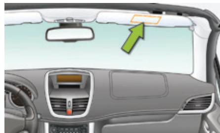
Отключение подушки безопасности пассажира ("OFF")
