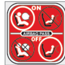
Отключение подушки безопасности пассажира ("OFF")
