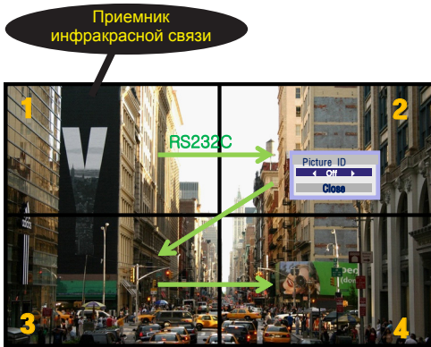
Мультикартинка 2X2 (всего идентификаторов устройств: 4) Идентификаторы устройств назначаются, как показано на картинке.
