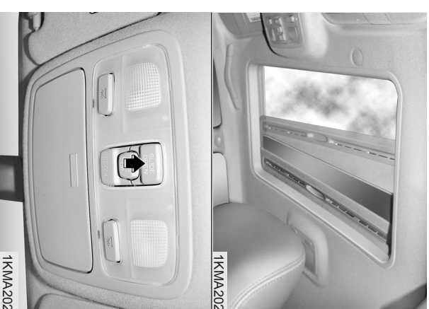
Сдвигание люка крыши
