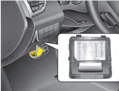
Внутренняя панель плавких предохранителей
