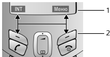
1 Текущие функции дисплейных клавиш 2 Дисплейные клавиши
